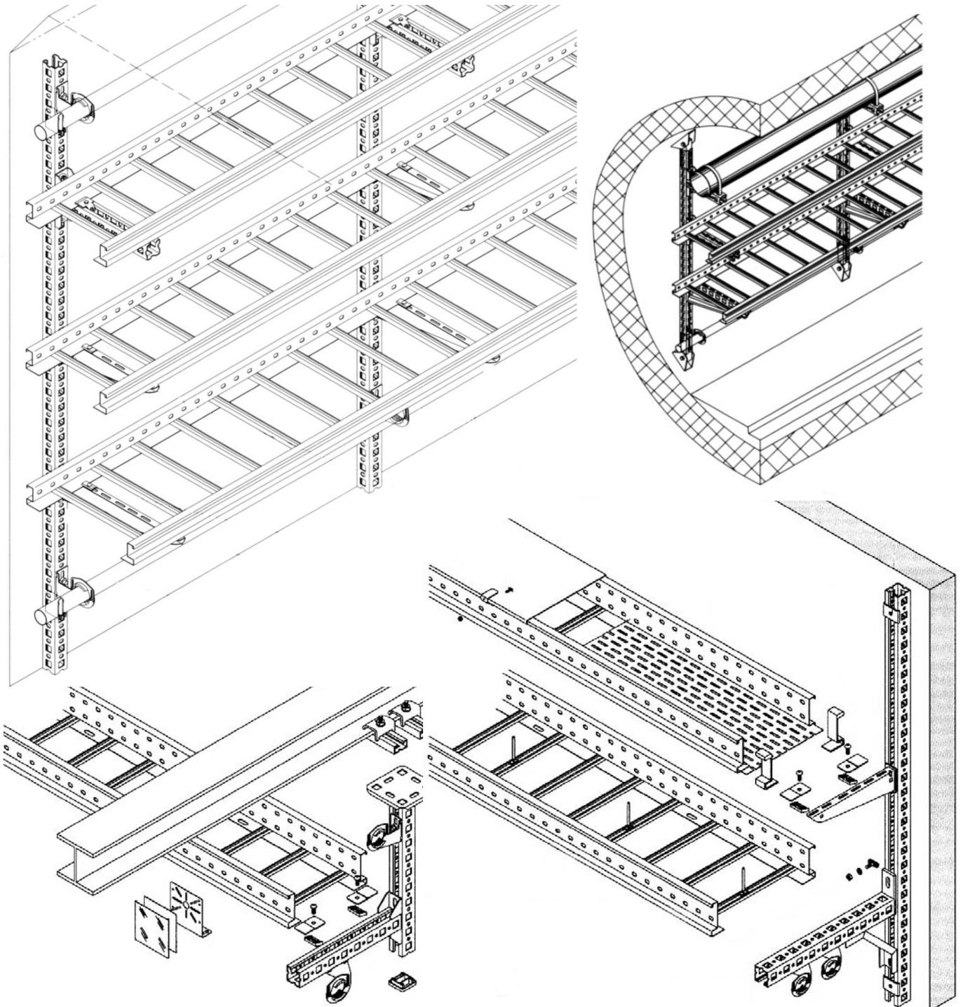
**Ihr CENTROfixss Vorteil:** Die Weitspann-Multibahn ist universell für schwere Kabelinstallationen mit großen Stützabständen bis zu 6 m einsetzbar. Auch das Trägermaterial gewährt eine maximale Sicherheit und ist auf Schocksicherheit geprüft. In grossen Fabrik-, Lager-, und Ausstellungshallen, in Medienschränken, in Bahn- und Strassentunnels etc. finden Sie das Centrofixss Weitspann-System.
