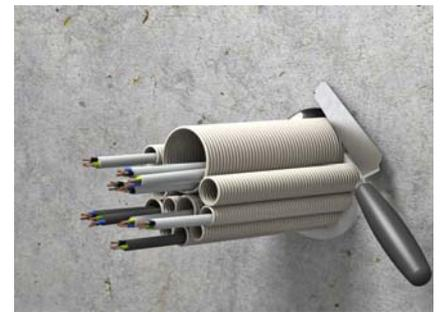
Bei Elektroinstallationsrohrbündeln die einzelnen Bündel z.B. mit Klebeband fest zusammenschnüren. Alle Restöffnungen in der Wand / Decke mit z.B. Mörtel oder Gips hohlraumfrei verfüllen.
