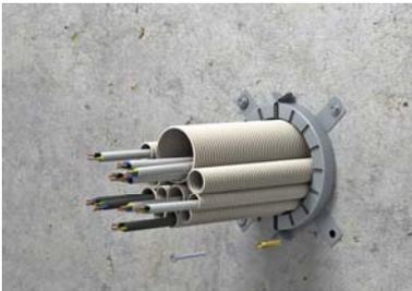
Ausgewählte Manschette mittels geeigneter Dübel oder Gewindestange befestigen. Bei Wänden eine Manschette pro Seite, bei Decken eine unterseitig der Decke.
