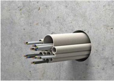
Installationsrohre mit oder ohne Kabelbelegung in die Öffnung einlegen. Die Elektroinstallationsrohre müssen mindestens 20 cm über die Wand / Decke hinausragen.
