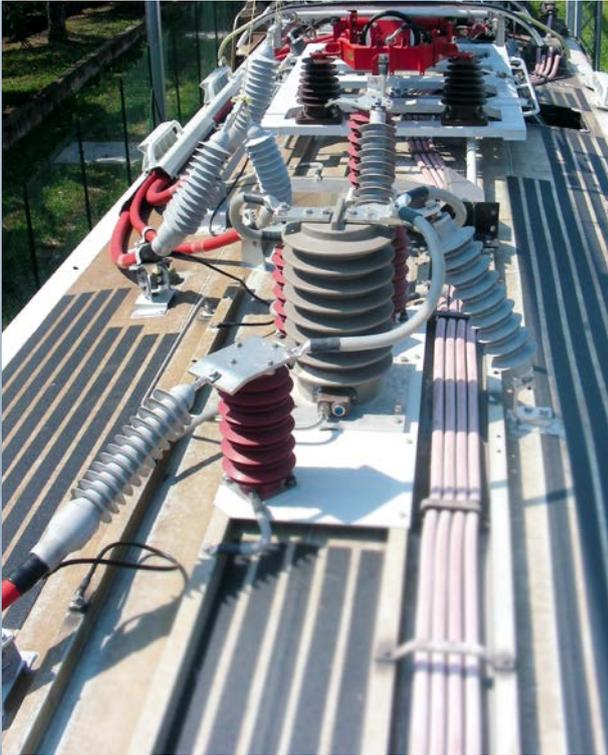
LEONI ist Experte für Design und Herstellung von Dachübergangssystemen. Zusammen mit konfektionierten Mittelspannungsleitungen und den zugehörigen Komponenten sind wir in der Lage, ein komplettes und durchgängiges Mittelspannungskabelsystem anzubieten.
