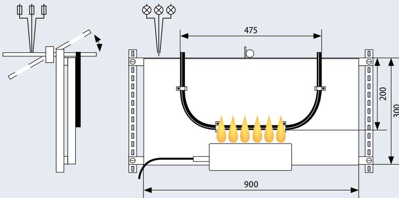
Notlaufkabel mit Durchmesser bis 20 mm werden nach dieser Norm unter Beanspruchung durch Feuer und mechanischen Schock geprüft.
