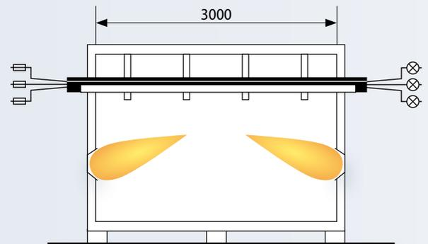
Nachweis des Funktionserhalts von Kabelanlagen im Brandfall. Die Prüfung umfasst sowohl die Kabel, wie auch die Verlegesysteme.
