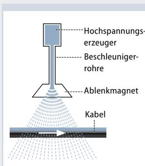
Mit Elektronenbeschleunigern werden die Isolierstoffe innerhalb weniger Sekunden vernetzt. Die homogene Bestrahlung und damit homogene Vernetzung wird durch speziell angepasste Handlingsysteme gewährleistet. Bei der Strahlenvernetzung werden keine Peroxyde oder Silane wie bei der chemischen Vernetzung in die Kunststoffmischungen eingearbeitet.
