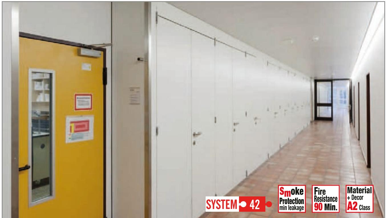
PRIORIT System 42 mm: mehrflügelige Revisionsöffnungsverschlüsse und Wandsystem
