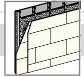
Einbau in Leichtbauwand GKF
