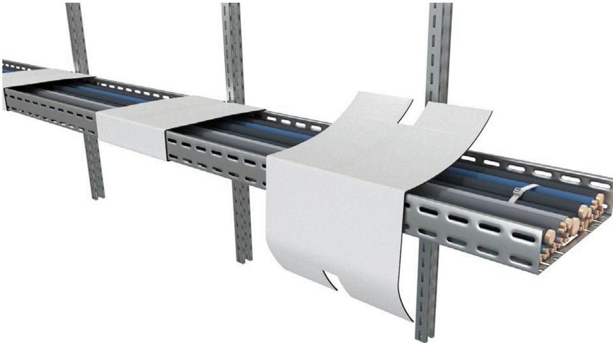
1. Bei elektrischen Leitungen in vertikalen Kabelanlagen (Steigtrassen) werden zunächst mindestens 10 cm breite Streifen aus **HENSOTHERM® 7 KS Gewebe 1000 E** mit Schere oder Messer zugeschnitten und mit passenden Aussparungen für die Kabelklemmen und Profilschienen versehen. Die Fixierung der Streifen erfolgt mit metallenen Spannband oder verzinktem Wickeldraht ( $\geq 0,6$  mm).
