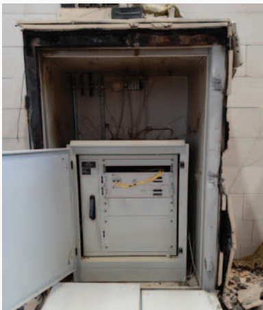
Gehäuse typgeprüft mit eingebauter BOS Anlage – Nach dem Brandtest, Brand von außen, Nachweis des Funktionserhalts über 90 Minuten
